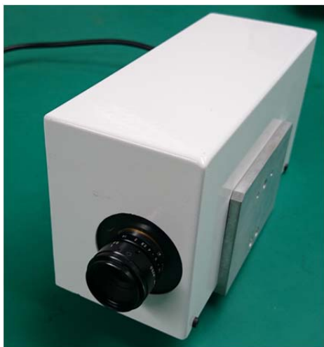
図5 探索実験用ハイパースペクトルカメラ
