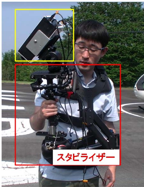
図7 小型ヘリコプター搭載用ハイパースペクトルカメラシステム
