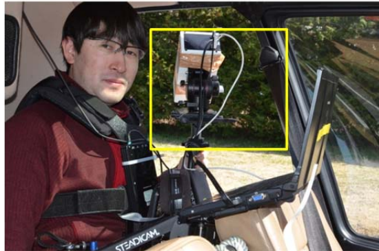
図7 小型ヘリコプター搭載用ハイパースペクトルカメラシステム
