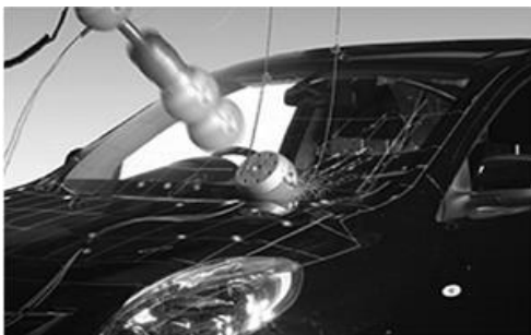
図 7 歩行者頭部保護性能試験 (http://www.nasva.go.jp/より)
