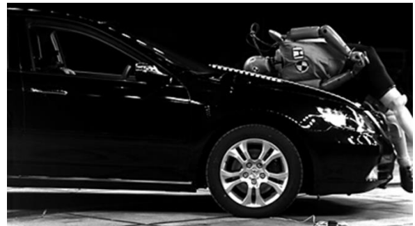
図 8 ポップアップ式フード (http://www.honda.co.jp/より)
