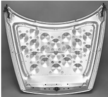
図10 衝撃吸収構造アルミボンネット ( http://www.mazda.co.jp/ より)
