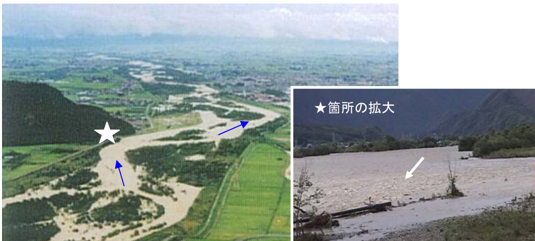
写真 3-4 流向変化による堤防侵食
