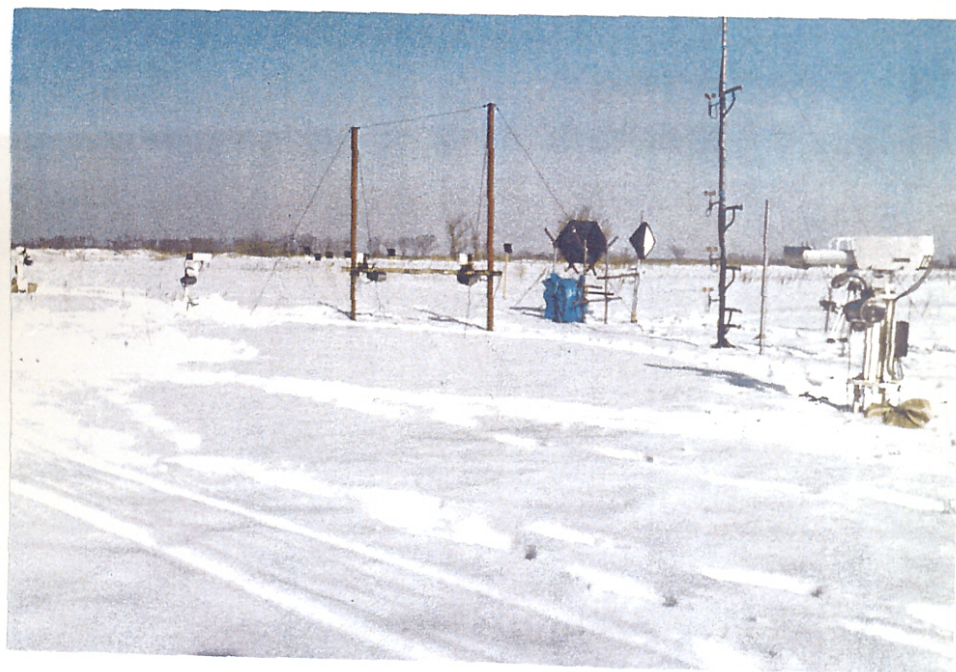
写真4.2.1 透過型視程計による吹雪時の視程観測状況 (石狩吹雪実験場)
