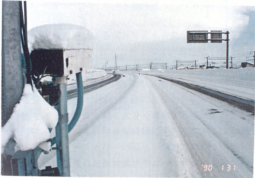
写真4.3.1 反射型視程計よるによる吹雪・雪煙による 視程障害の観測状況(一般国道12号江別)
