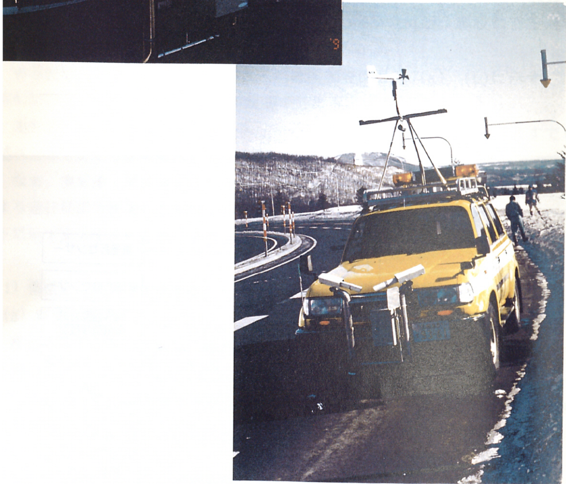
写真4.2.3 車載型視程計を搭載した視程障害移動観測車
