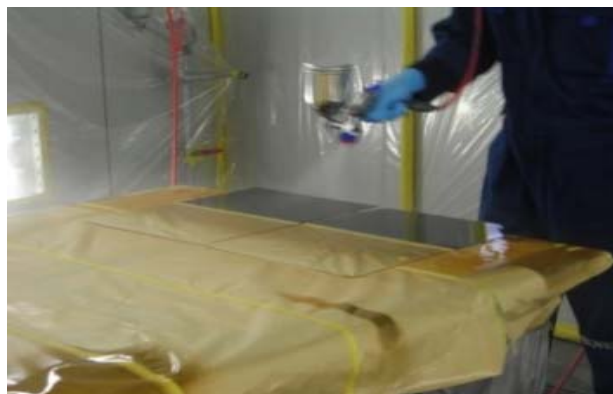
図 9 耐スリ傷クリヤー塗布
