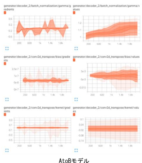
図7 バッチ正規化係数 \gamma (上), バイアス (中), カーネル (下) の値と勾配の時間変化 (U-Net デコーダ部分 2 層目, TensorBoard により表示)
