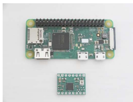
図3 マイクロコンピュータ Raspberry Pi Zero (上), モータドライバモジュール A4988 (下)
