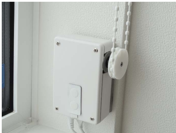
図 7 ロールスクリーン用入射制御デバイス (ボールチェーンアタッチメント使用)
