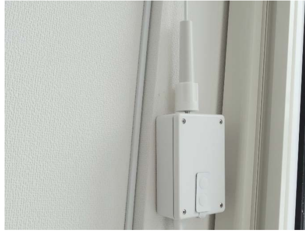
図 8 バーチカルブラインド用入射制御デバイス (ボタンアタッチメント使用)
