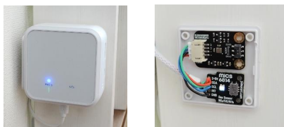
図3 空気質センシング IoT デバイス : CO 2 , PM 2.5 センサ (左), TVOC センサ, CO, NO 2 センサ (右)
