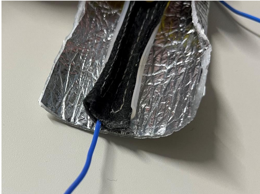
(a) 加温温度の測定：ヒータパッド内部に留置した熱電対
