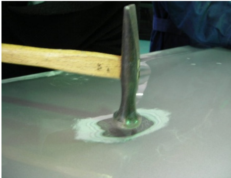
図 14 板金ハンマを使用した作業
