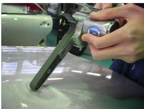
図 9 ベルトサンダーを使用した作業
