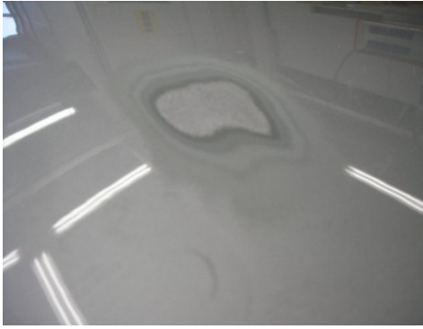
図 13 ヤスリハンマによる修理結果
