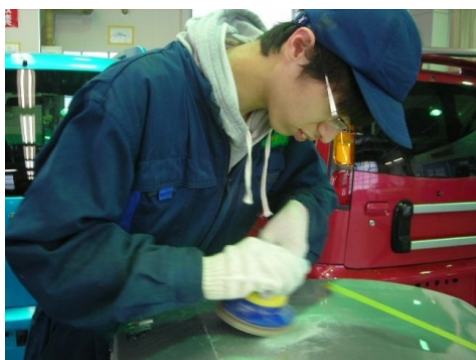
図 8 ダブルアクションサンダーを使用した作業
