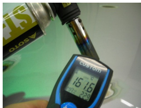
図 11 ガスバーナを使用した絞り作業
