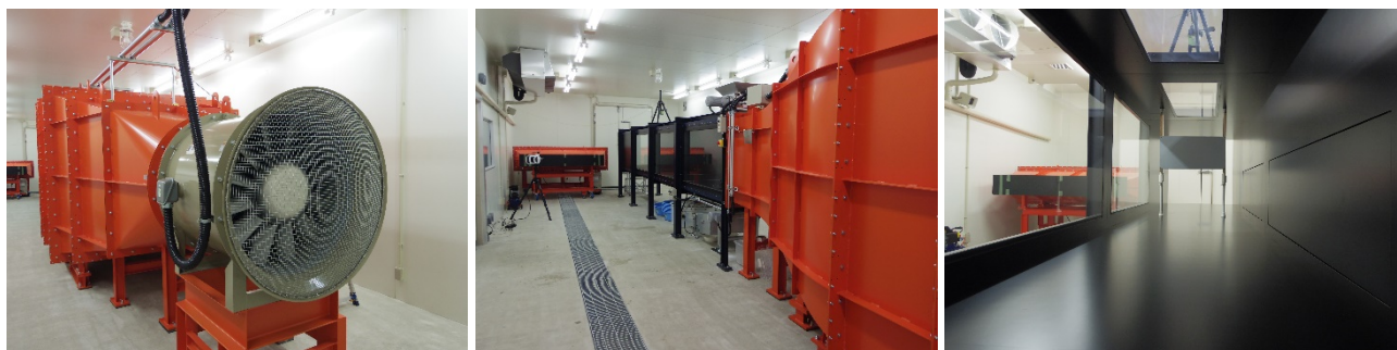
写真1 自然雪風洞装置の概要
