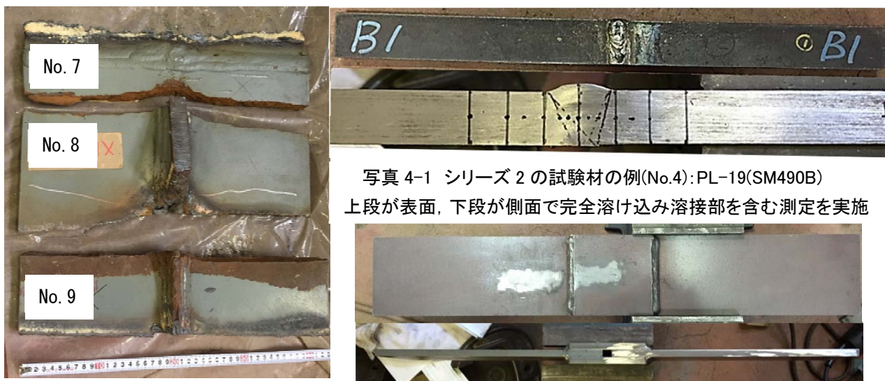
写真 3-3 シリーズ 1 の試験材 (No.7~9): PL-25(SM490A)
