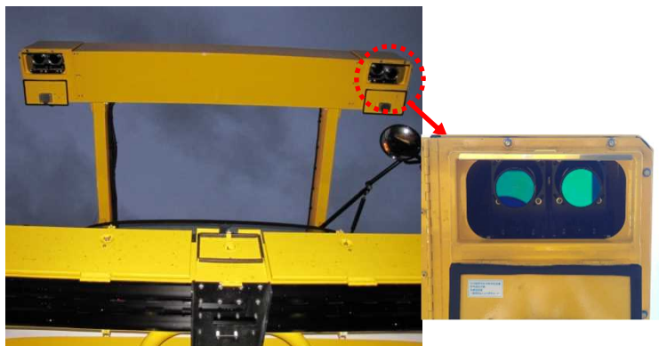
写真-2.3 レーザスリット灯光器の照 写真-2.4 ラインセンサカメラ（右：拡大図）
