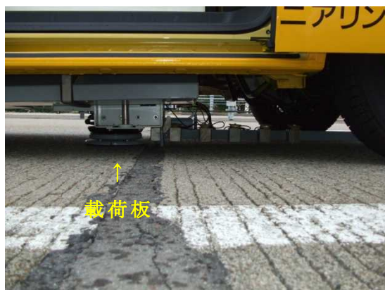
図-2.8 FWD の概略図と載荷状況
