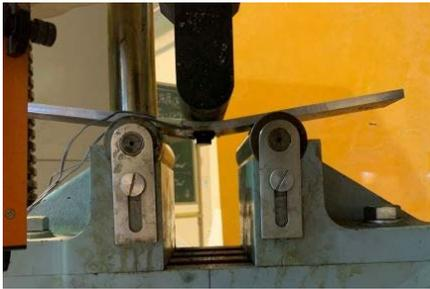
写真5 押し曲げ試験時の様子
