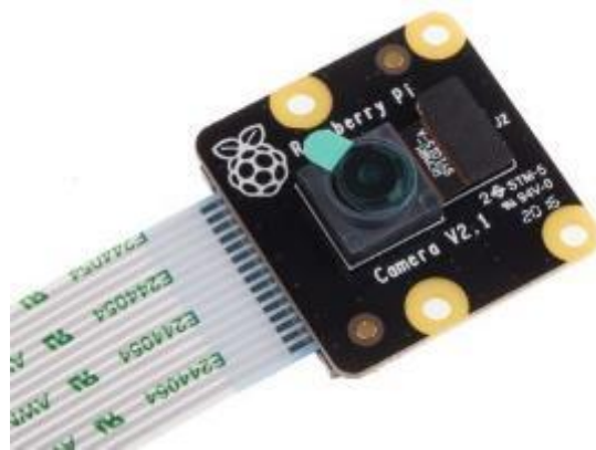
図 4.2 Compact カメラ (Pi NoIR Camera V2)
