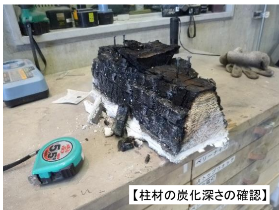
写真 6.5 試験体の炭化状況
