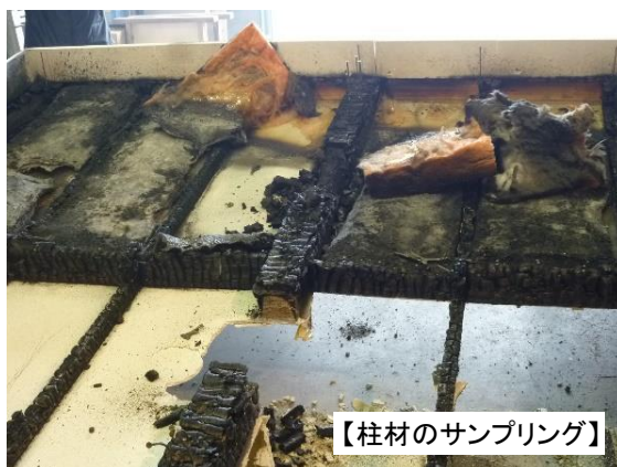
写真 6.5 試験体の炭化状況
