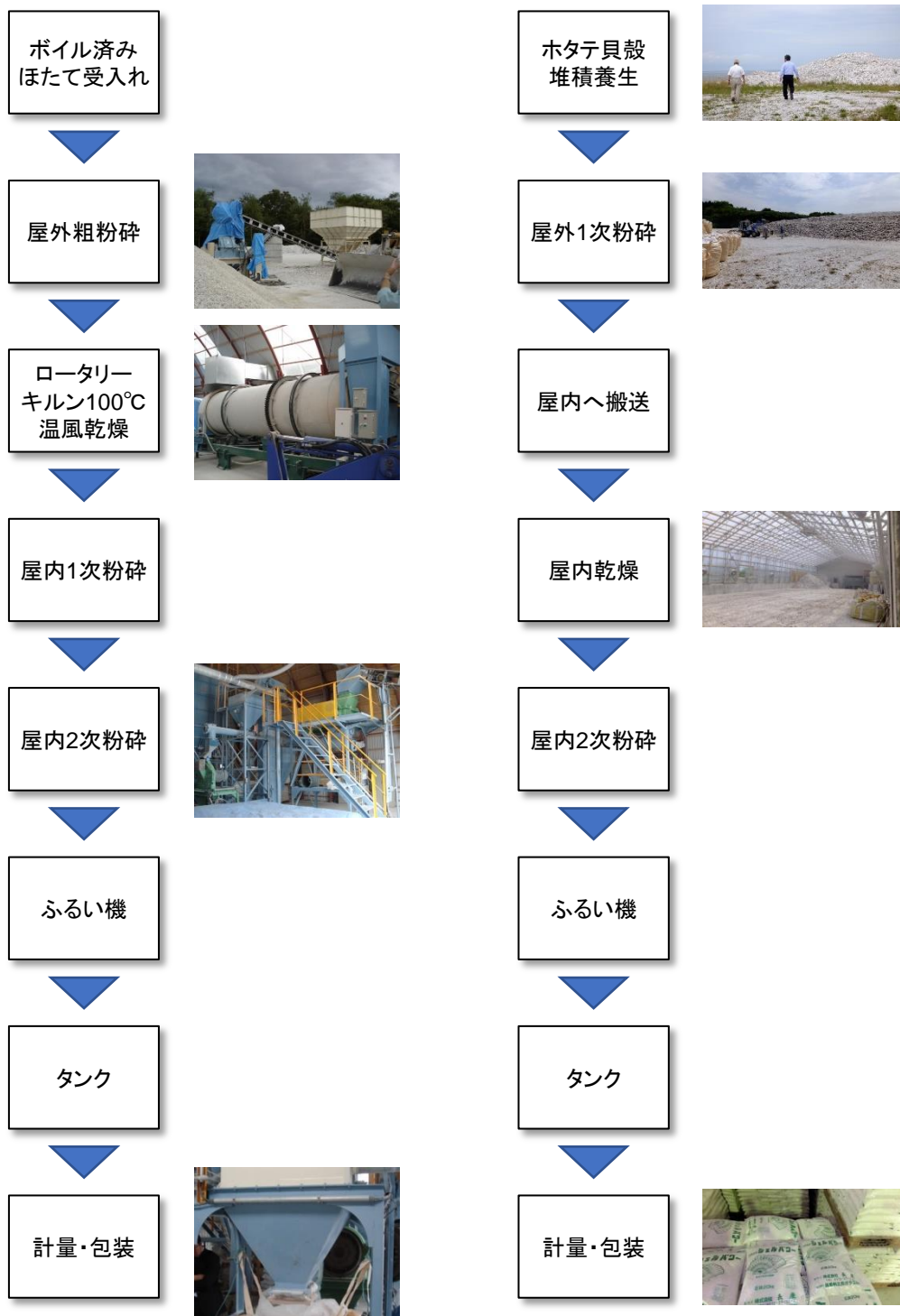
図 3.1 調査した 2 工場におけるホタテ貝殻粉末の製造工程
