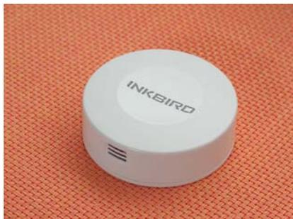
図 1 Inkbird 製 温湿度スマートセンサ IBS-TH1
