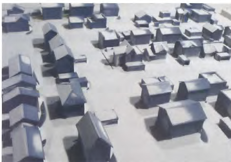
写真 7-1 住宅地を対象とした吹雪風洞実験
