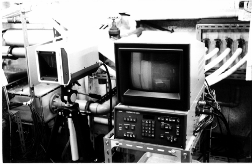
図3. 16 サーマグラフィ装置
