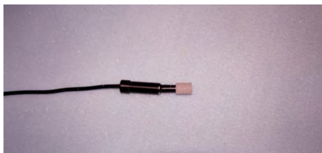
図2. 8 多孔質層内用湿度センサー
