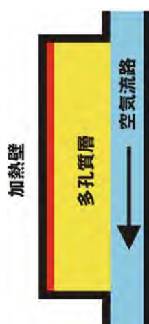
図3.100 実験装置Ⅱc-1および2の概要
