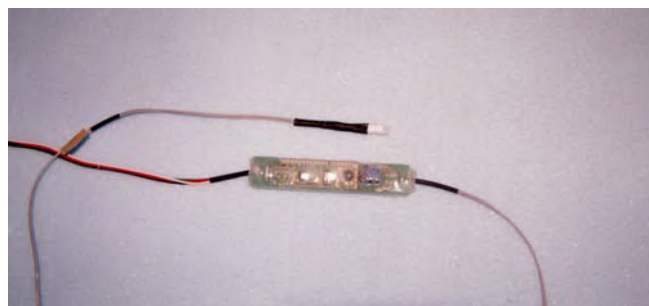
図2. 9 加熱・冷却室用湿度センサー
