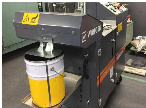
写真-5-1 Wirtgen 社製フォームド As 発生装置
