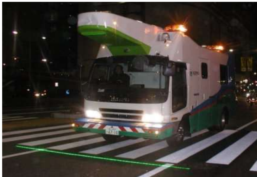
写真-1.3 路面性状測定車によるひび割れ測定例
