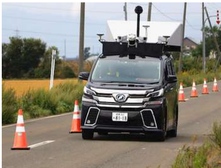
写真-2.4 使用した路面性状測定車の調査状況
