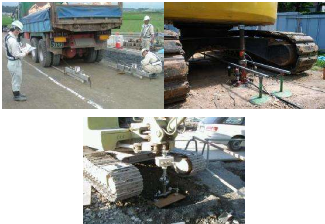
写真-1.8 左：ベンケルマンビーム，右：平板載荷試験，下：現場 CBR 試験
