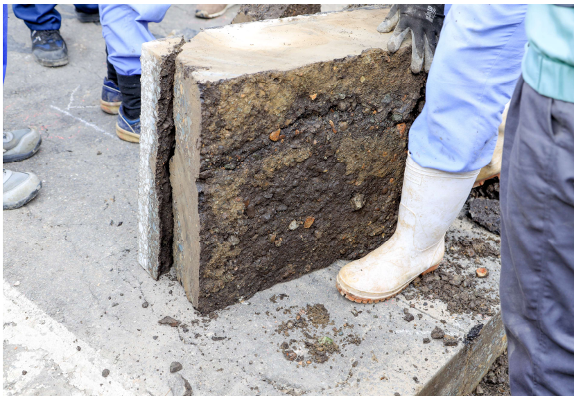
写真-1.13 取り除いた舗装の下面の状況
