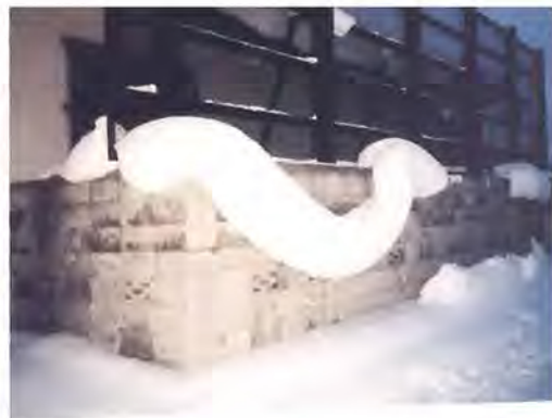
写真 4-4-4 積雪のクリープ変形(旭川市)
